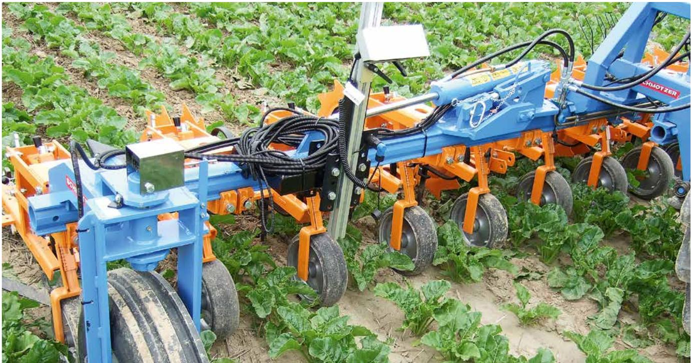
Gesteuert mit Kamera und GPS: Unkrauthackgerät im Rübenfeld. | Machine téléguidée équipée d'une caméra et d'un GPS : bineuse dans un champ de betteraves
