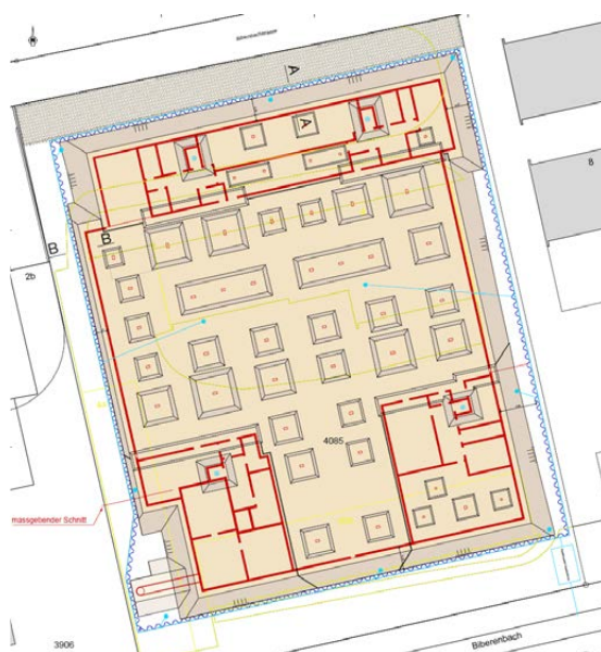
Baugrube mit geplantem Abschluss
