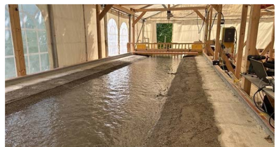
Wasserbaumodell bei Laufendem Versuch mit mehreren Buhnen
