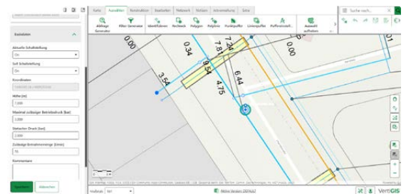
GIS-Oberfläche zur Bearbeitung eines Netzobjekts mit Lage und Attributen.
