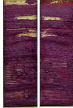
Abb. 6: Eingefärbte Scherfläche von Bohrkernen mit einem Faserbruchanteil von 100 % (links) und ca. 75 % (rechts)
