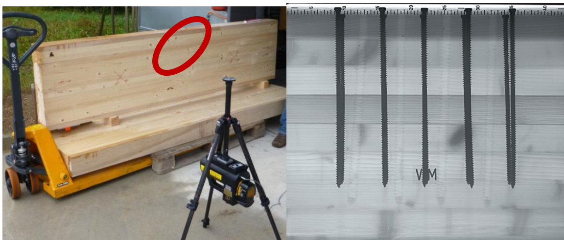
Figure 1: Untersuchung von Verstärkungen im Auflagerbereich, Träger (links) und Röntgenbild mit selbstbohrenden Schrauben und Hohlräumen (rechts)
