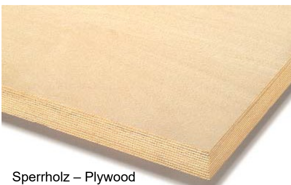
Abb. 5: Übersicht der am häufigsten verwendeten Holzwerkstoffe bei der Verstärkung von Brettschichtholz. Mit angegeben sind die minimal anzuwendenden Dicken der gesamten Werkstoffplatten bzw. die maximale Dicke einzelner Lagen dieser Holzwerkstoffe.
