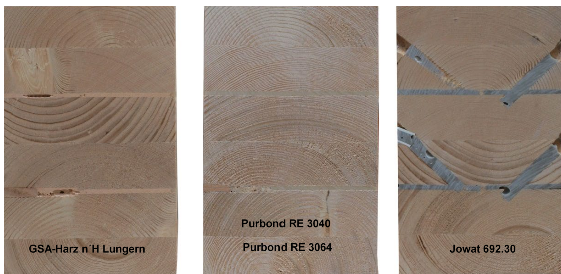
Abb. 1: Im Rahmen des AP Holz Projektes "Zustandserfassung und Verstärkung von BSH-Bauteilen" hergestellte Prüfkörper mit drei verschiedenen 2K-Klebstoffsystemen und unterschiedlichen Methoden der Klebstoffinjektion. Die teilweise erkennbaren Fehlstellen sind nur lokal vorhanden und meist auf die unmittelbare Umgebung der Injektionsöffnungen beschränkt. Bei Versuchen erreichten alle 3 Systeme ähnliche Festigkeiten.
