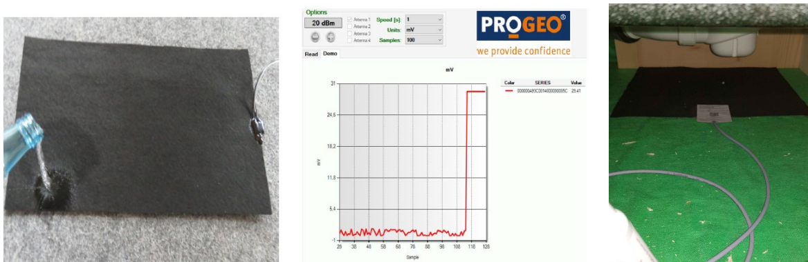
Abb. 12: Flächensensor «smartex sp» der Firma ProGeo für die Detektion von Feuchtigkeit (links), Auswertung der Messdaten im Monitoringportal (mitte) und Installation des Flächensensors in einem schwer zugänglichen Ort unter einem Wasserablauf (rechts)
