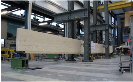
Abb. 4: Überprüfung der Leistungsfähigkeit durch Versuche mit Bauteilen im Masstab 1:1 an der EMPA Dübendorf und anschliessender Anwendung in einem zu sanierenden Dachtragwerk.
