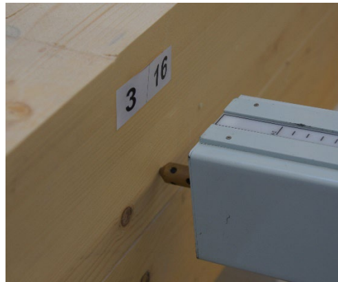
Abb. 4: Angesetzte Spitze des Bohrwiderstandsmessgerätes
