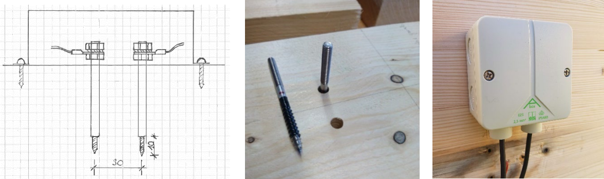
Abb. 3: Prinzipskizze und Fotos des Einbaus von Stockschrauben-Elektrode und Schutzbox, Müller et al. (2021)
