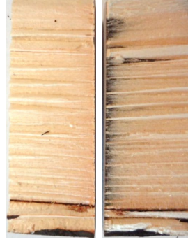
Abb. 7: Nicht eingefärbte Scherfläche von Bohrkernen mit einem Faserbruchanteil von ca. 95 % (links) und von ca. 65 % (rechts)
