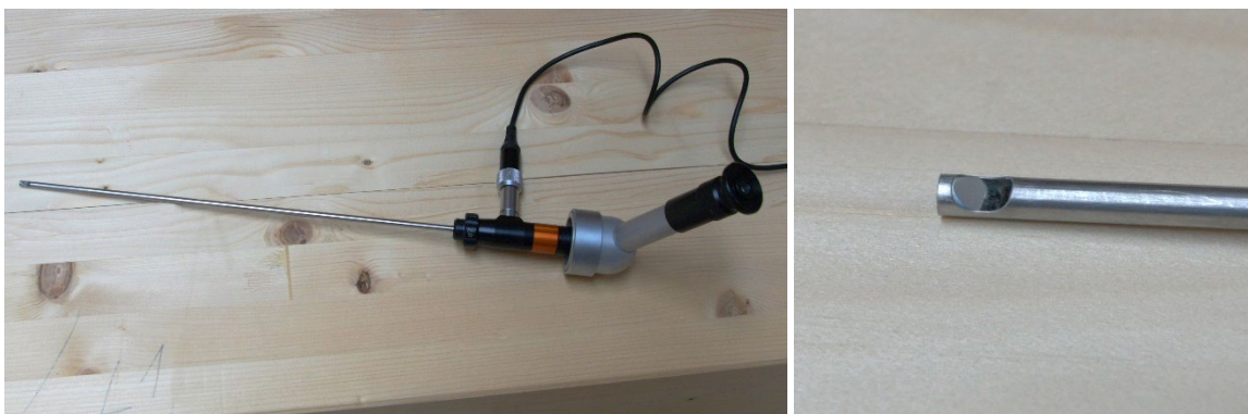
Abb. 7: Starres Endoskop, zusammengesetzt (links), Spitze der Objektivsonde mit Ablenkspiegel (rechts)
