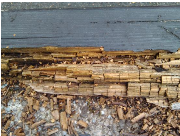
Abb. 2: Braunfäule mit typischer Würfelstruktur an einer Parkbank
