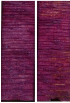
Abb. 6: Eingefärbte Scherfläche von Bohrkernen mit einem Faserbruchanteil von 100 % (links) und ca. 75 % (rechts)
