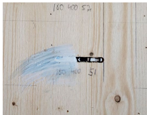
Abb. 4: Einbau von Lufttemperatur und relativer Luftfeuchte-Sensoren in Massivholzwände
