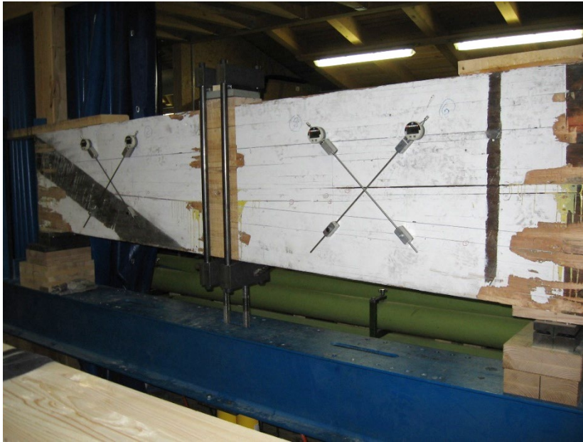
Abb. 12: Prüfung Träger mit natürlichen Rissen
