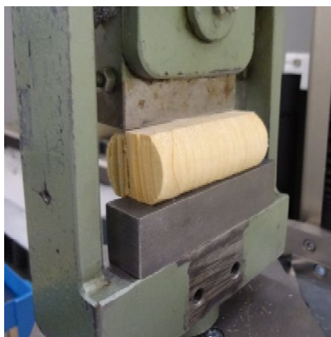
Abb. 4: Bohrkern in der Prüfmaschine
