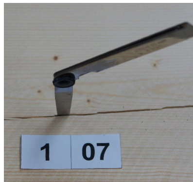
Abb. 22: Risstiefenmessung mit Blattlehre an Pos. 1/07
