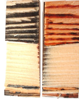
Abb. 7: Nicht eingefärbte Scherfläche von Bohrkernen mit einem Faserbruchanteil von ca. 95 % (links) und von ca. 65 % (rechts)
