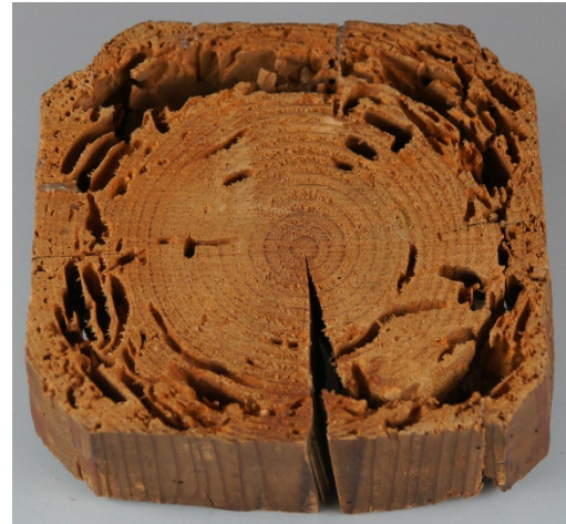
Abb. 12: Pilzbefall aufgrund zu hoher Holzfeuchte, Blättling Abb. 13: Schadensbild eines Hausbockkäfers
