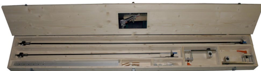
Abb. 10: Luftunterstützter Bohrer System Fankhauser
