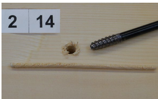
Abb. 1: Spitze des Zuwachsbohrers, Bohrloch und Bohrkern
