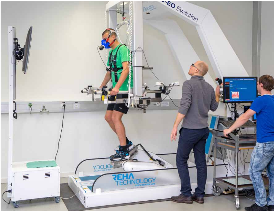
Das Institute for Rehabilitation and Performance Technology IRPT setzt in Zusammenarbeit mit der Reha Rheinfelden Rehabilitationsroboter für Fitness-Evaluation bei schwer betroffenen Patienten ein.
