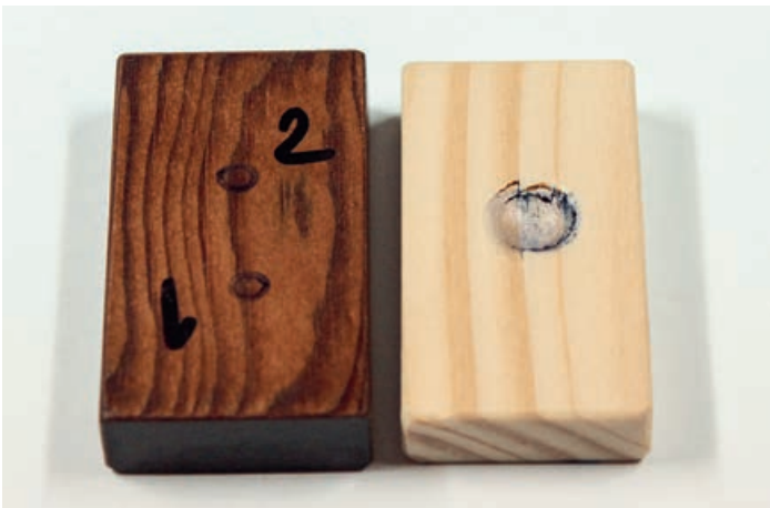
Lässt man eine Stahlkugel auf das Holz fallen, hinterlässt das beim verdichteten Holz (l.) geringere Spuren.
