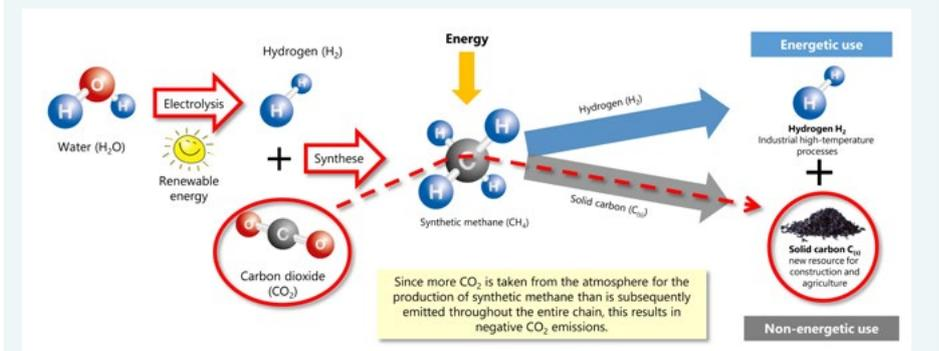
Bilan carbone négatif : Si seul l'hydrogène H<sub>2</sub> était utilisé comme énergie à partir du gaz naturel synthétique, le carbone C serait retiré du cycle du CO<sub>2</sub> par pyrolyse, ce qui réduirait sa concentration dans l'air. Photo : Empa
