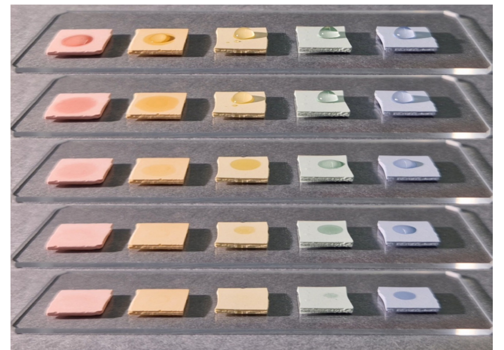
Abb. 3: Saugfähigkeitstest auf den farbcodierten Referenzschollen (ca. 1 cm 2 ) mit je 5 µl deion. Wasser. Dabei ist ersichtlich, wie die verschiedenen Schollen das Wasser unterschiedlich schnell aufnehmen. Die Stufen der Skala werden von li. nach re. eingeordnet: sehr stark saugend (1) bis nicht/wenig saugend (5). (V.S. Murgia 2023)
