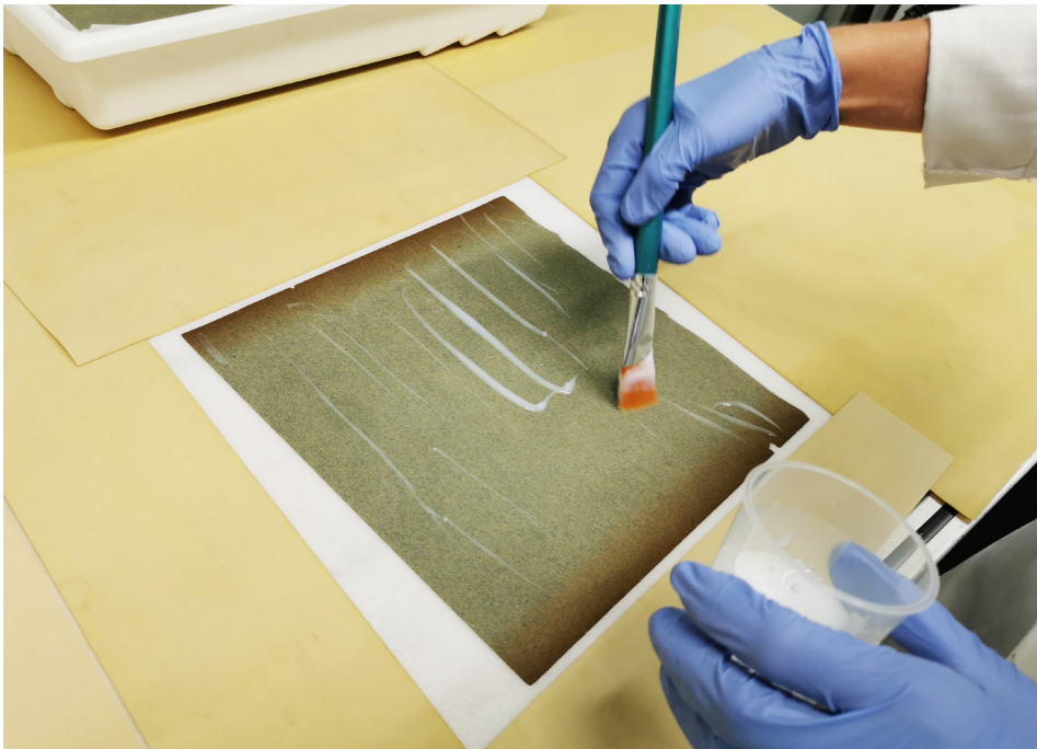
Abb. 1: Auftrag von 1,5%iger CNF-Dispersion auf Albumpapier mit Hilfe eines synthetischen Flachpinsels (I. Alaeva 2023)
