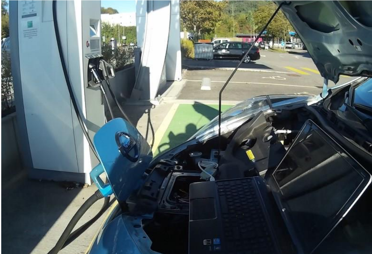
Abb. 8: Aufzeichnen des CAN-Protokolls an einer kommerziellen Ladesäule
