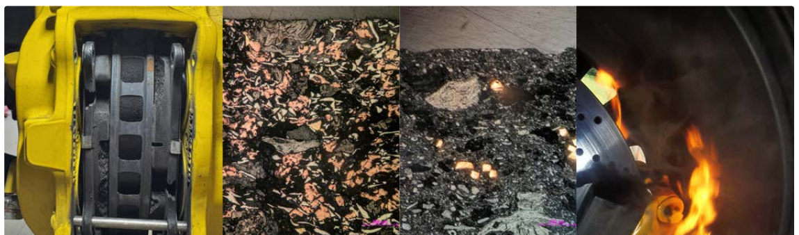
1. Plaquettes Alibaba effritées, 2. Garniture Ferodo riche en cuivre, 3. Plaquette Alibaba poreuse et pauvre en cuivre, 4. Début d'incendie au frein avant.
