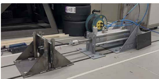
Abb. 1: Prüfstand für Dauerfestigkeitsversuche an CFK-Sandwichplatten zur Untersuchung der Lebensdauer
