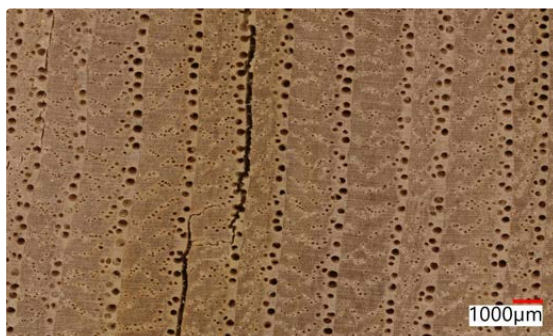
Abb. 1: Mikroskopische Aufnahme eines Querschnitts mit Ringschäle ( Castanea sativa Mill.).
