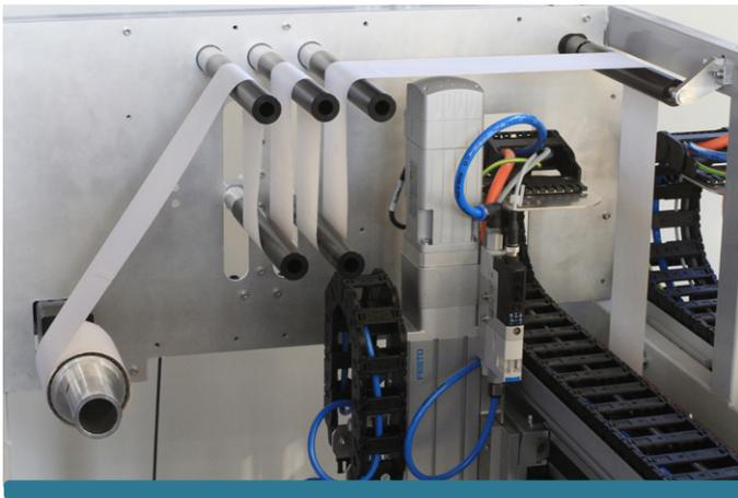
Abb. 3: Tänzerregelung der Separatorzuführung
