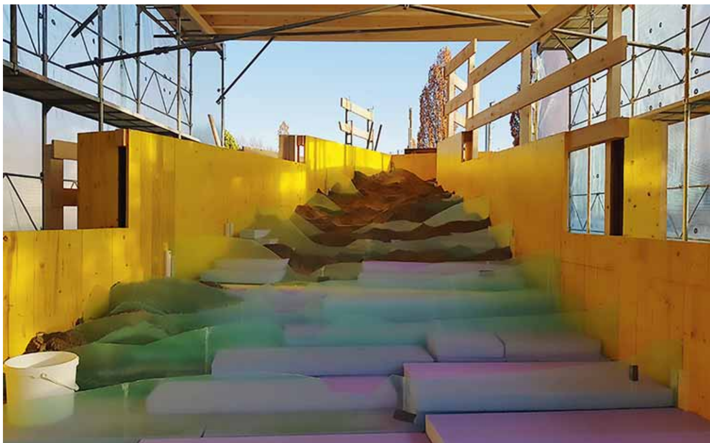
Mise en place du modèle du Rotenfluhgraben à l'échelle 1:30. On y a mené 60 essais pour estimer des dangers liés aux laves torrentielles.
