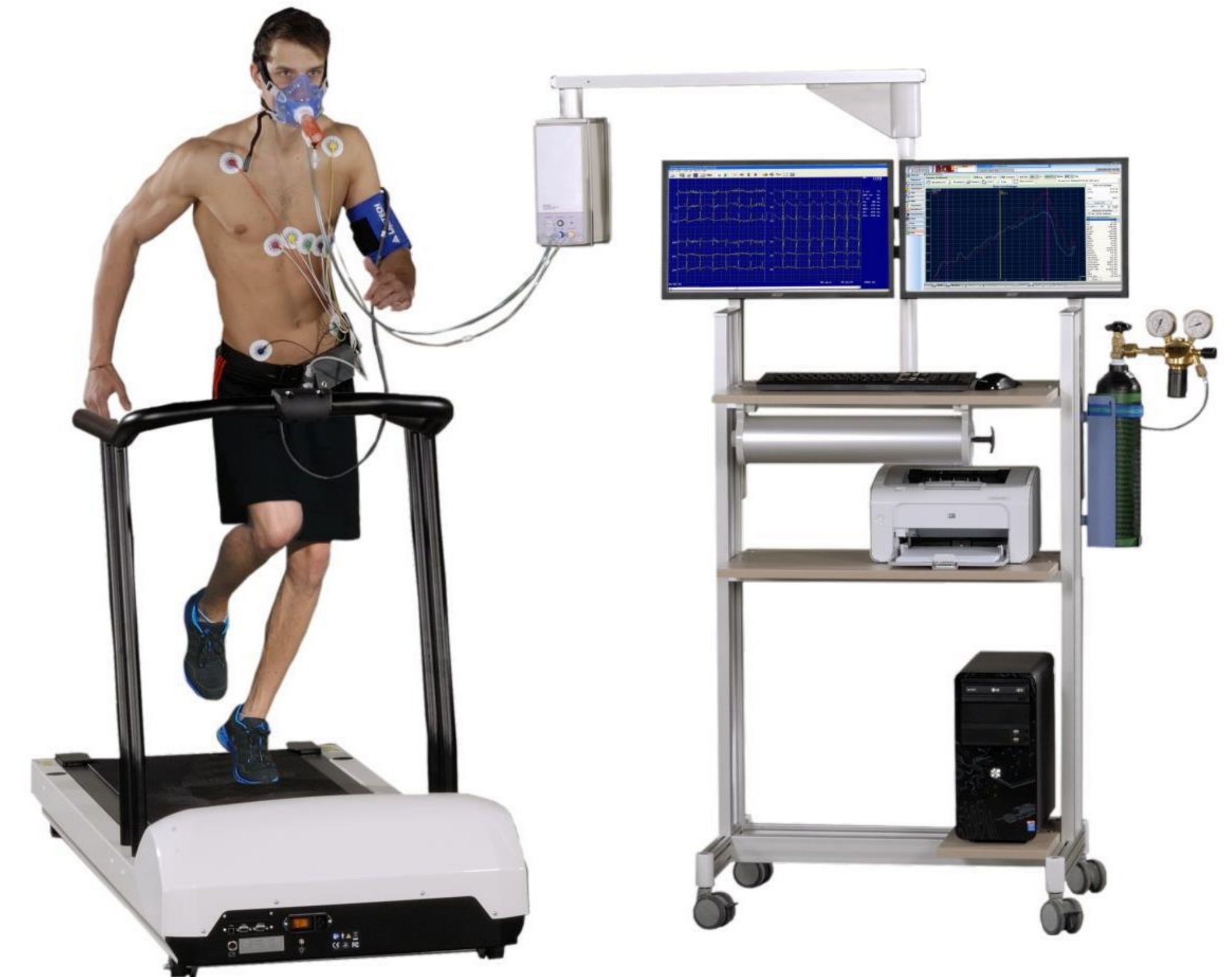
Abbildung1: Beispiel eines Spiroergometrietests auf dem Laufband [9]
