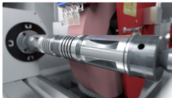
Rundschleifen einer zwischen Spitzen eingespannten Welle
