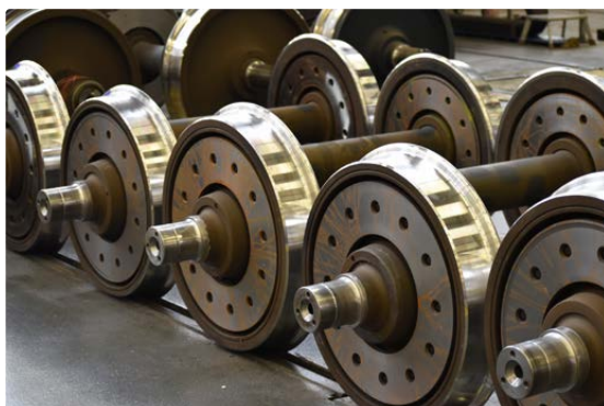
Radsätze eines FLIRT-Triebzuges mit Rad, Radbremsscheibe und Radsatzwelle
