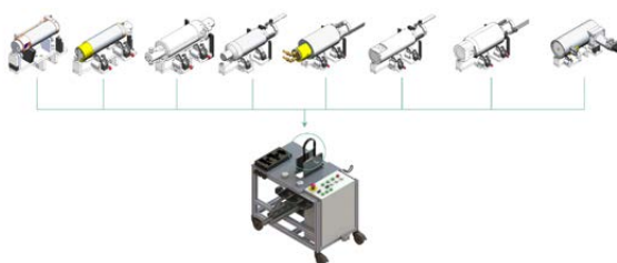
Messwagen Konzept mit dazugehörigen Röhrenhalterungen
