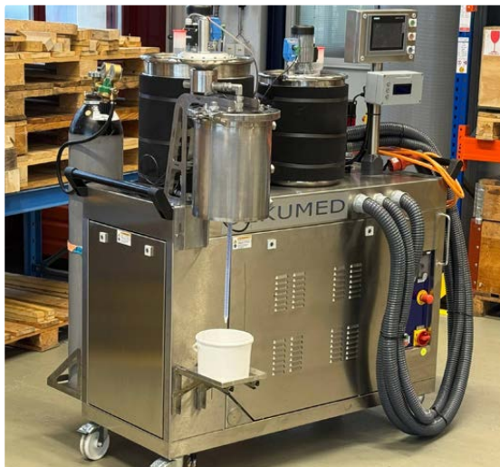
Inertisierungssystem an Misch- und Dosieranlage
