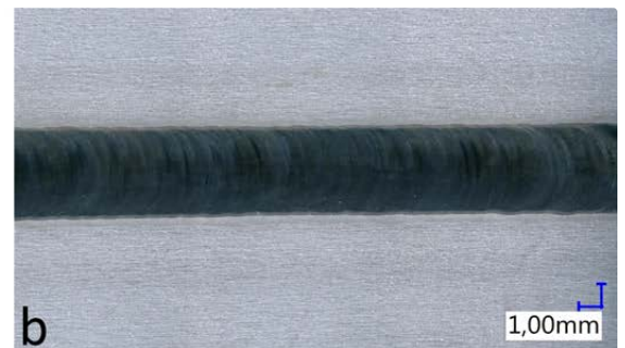
Abb. 1a und 1b: WIG-Schweissnaht mit Anlauffarben (1a) und ohne Anlauffarben (1b). Die Bildung von Anlauffarben konnte durch Optimierung des Wasserstoffgehaltes im Schutzgas vermieden werden.
