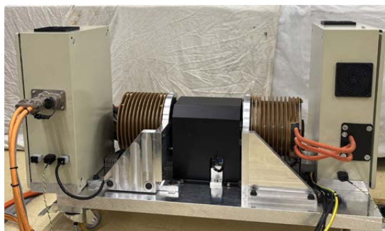
Fertig installierter Back-to-Back-Prüfstand mit beiden Permanentmagnet-Synchronmaschinen
