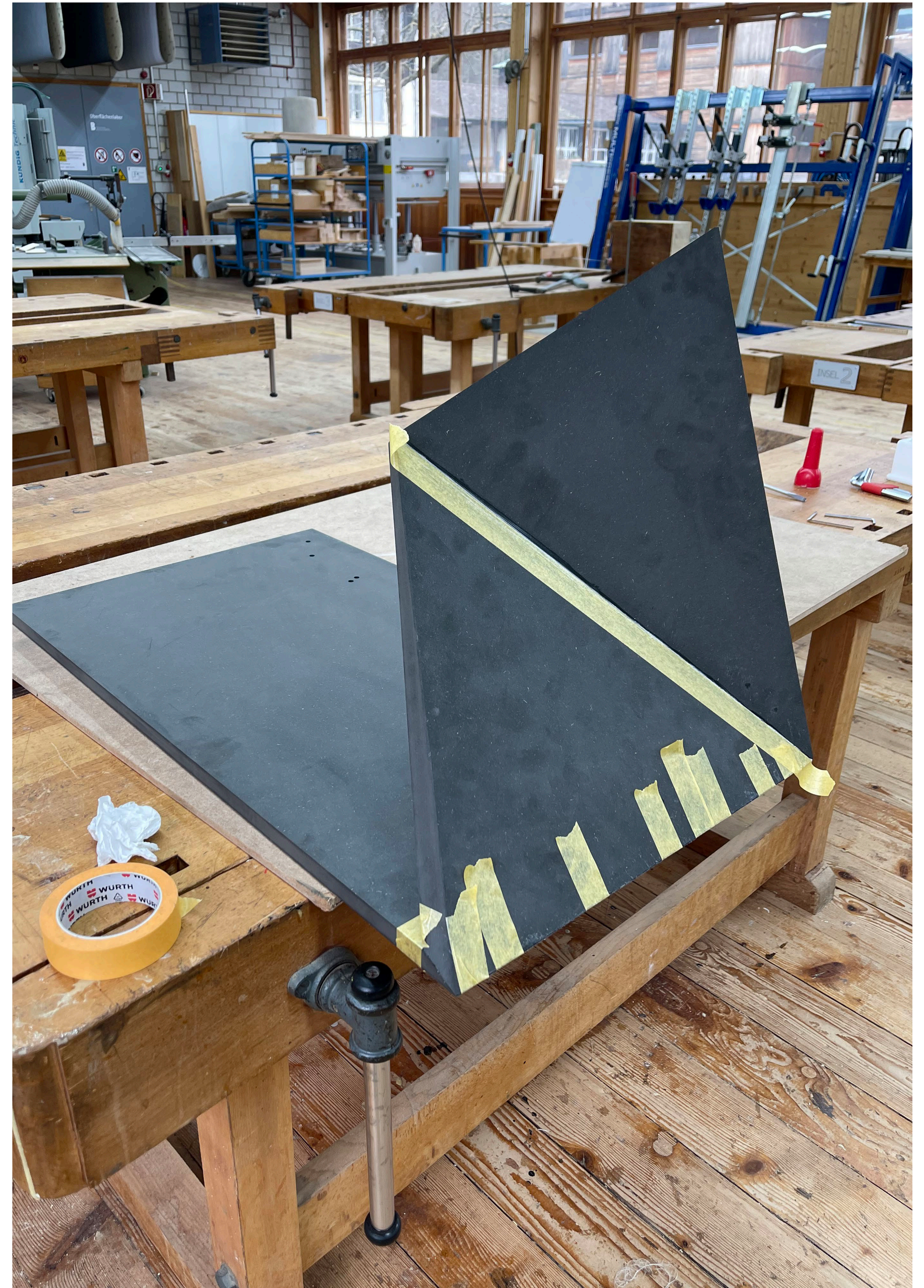
Verkleben der Platten
