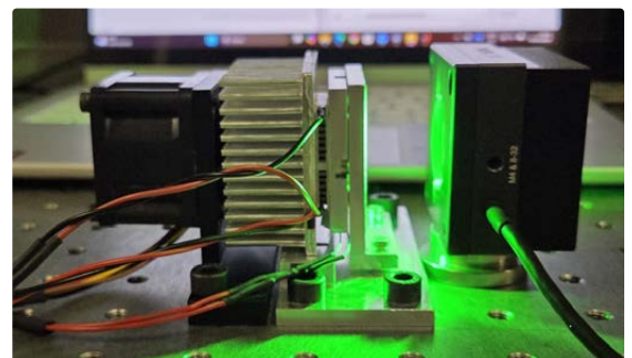
Messung der optischen Ausgangsleistung der Laserdiode
