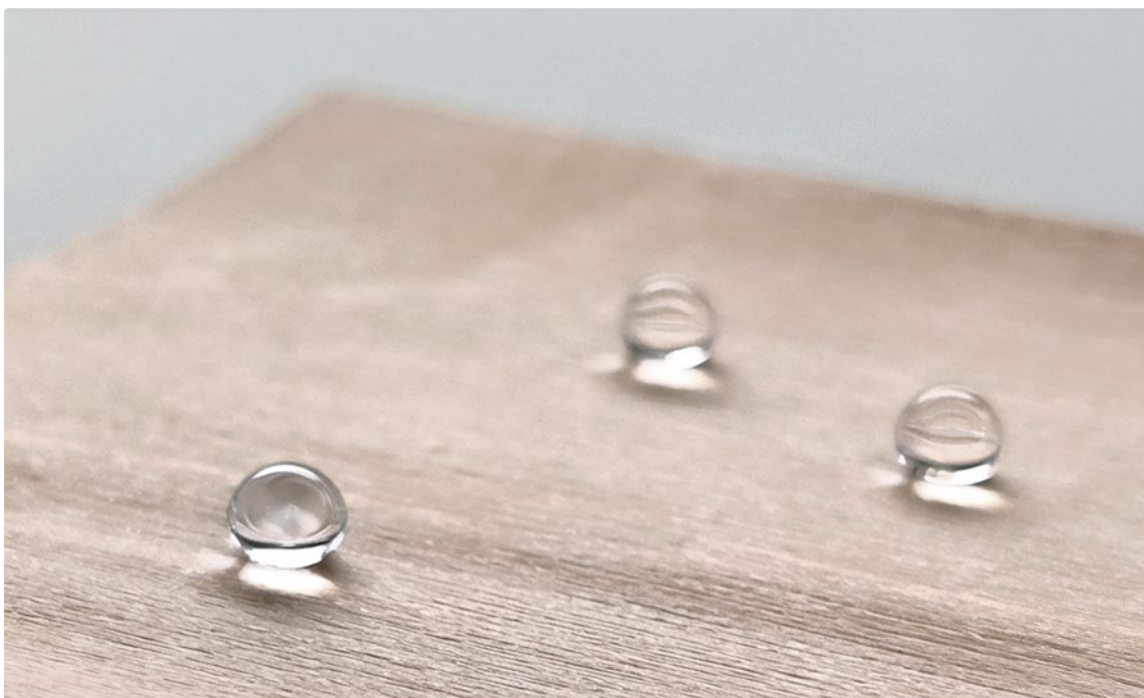
Durch die veränderten Mikro- und Nanostrukturen des Holzes perlt Wasser von der Oberfläche ab. (Foto: BFH)
