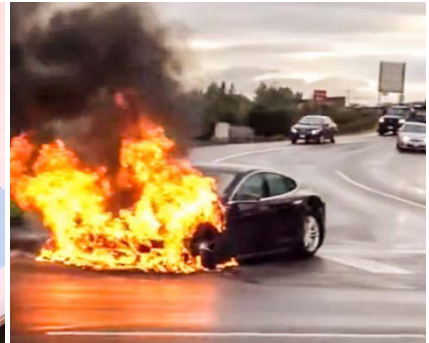
2013: Batteriebrand eines Tesla Model S ausgelöst durch Kollision mit einem harten Metallgegenstand. 3
