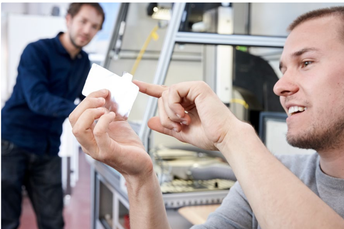
Gelaserte Stromableiter: Die Laserautomation ist vollständig parameterbasiert und ermöglicht eine flexible Geometrie.
